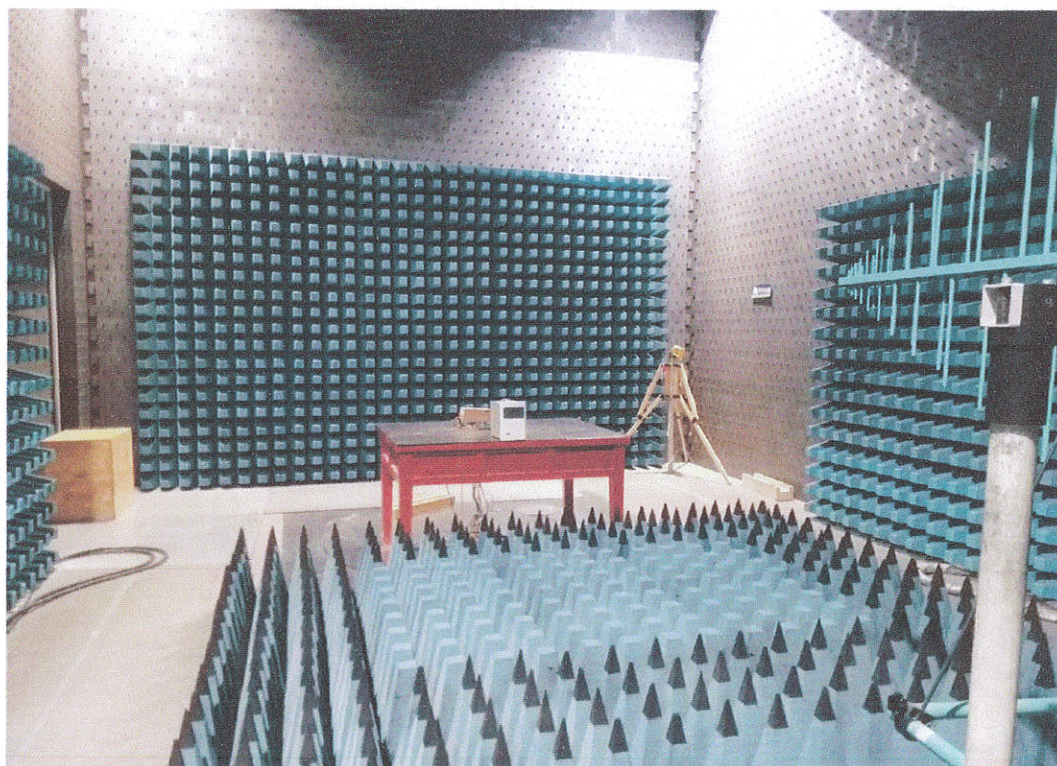
图 3: 射频电磁场辐射抗扰度检验配置图
