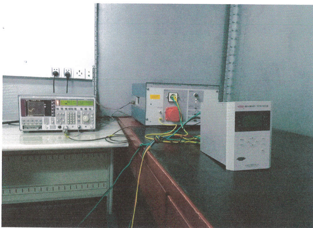
图 2: 传导发射限值检验配置图
