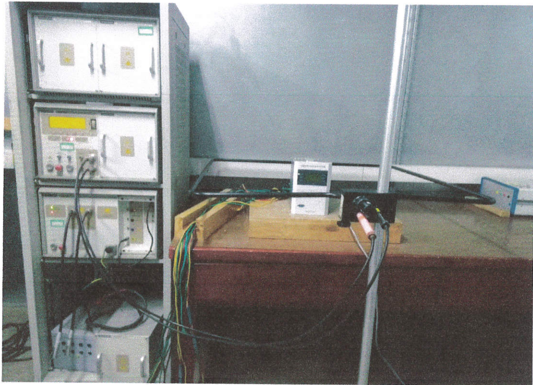
图 11: 阻尼振荡磁场抗扰度检验配置图
